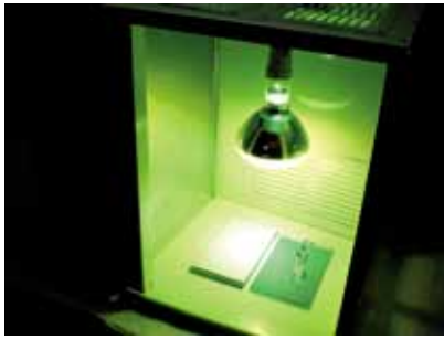
Envejecimiento: Comparación de transparencia antes y después del envejecimiento UV.
