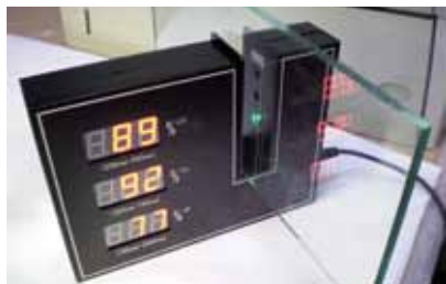
Transparencia: Espectrofotómetro (alrededor de 150 euros).
