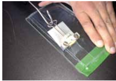
Tenacidad: Probeta de vidrio laminado de 2 cm. con tracción.
