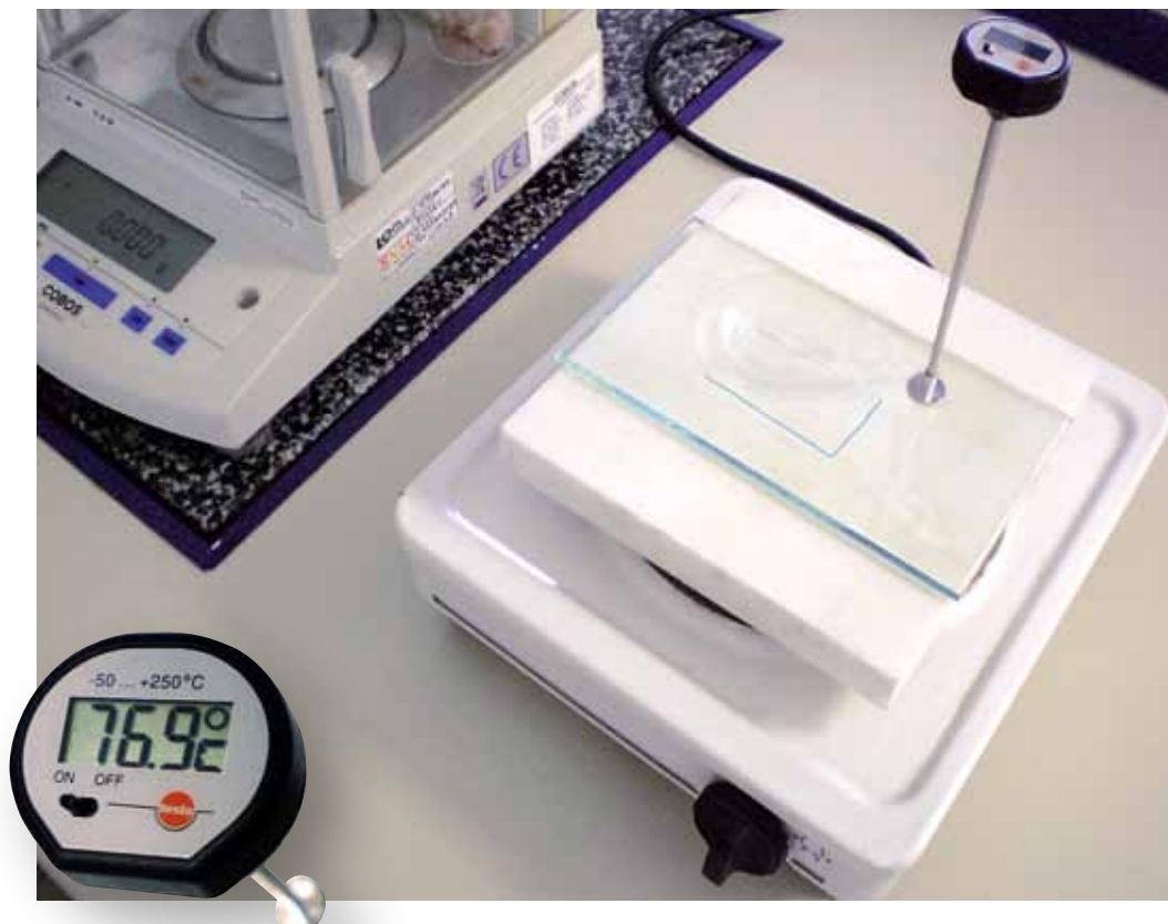
Comprobación del punto de fusión.
